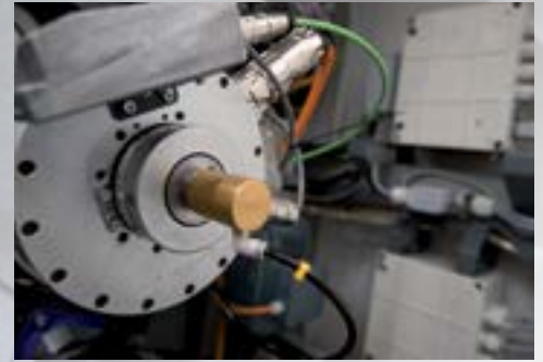
Безредукторные моментные двигатели на сливе и красочном аппарате
